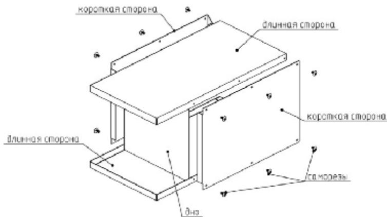
5.4 Установите подставку на ровную горизонтальную плоскость опорными поверхностями. Разместите в подставке огнетушитель. Корпус огнетушителя должен опираться на дно подставки.
